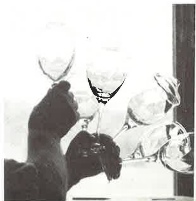
När benet är färdigt tar fotmakaren över. Fotanfångaren kommer med glasmassa som han fångat ut på sin »spik». Fotmakaren jäster den glödande massan vid benet och klipper av med skarsaxen.
