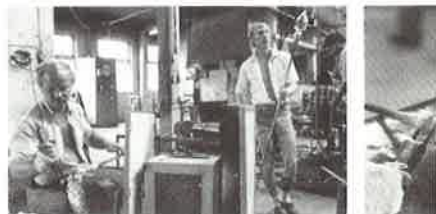
När kupan har formats av uppblåsaren tar mästaren över och formar med sin skarsax ut ett ben från den lilla glasklump som sitter på kupan.
