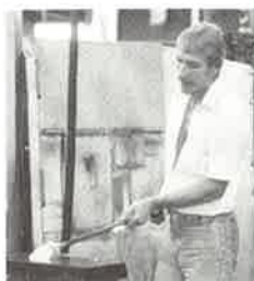
När han skall göra ett vinglas börjar uppblåsaren med att »fanga an» en lagom mängd av den drogflytande glasmassan på pipan, varefter han rullar pipan mot ett bleck och grovformar ämnet till en kon. Så blåser han till ett ögonblick i pipan, varvid glasmassan blir till en bubbla.
