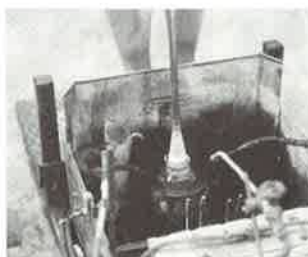
Den efter gör uppblåsaren till en form, i vilken han »stärper» glasämnets, samtidigt som han blåser upp det till en kupa. I formen får kupan den »optik», den raffling, som ger just det här glasets dess prägel. Blåsaren av gör skickligt hur tjockt glaslet blir.
