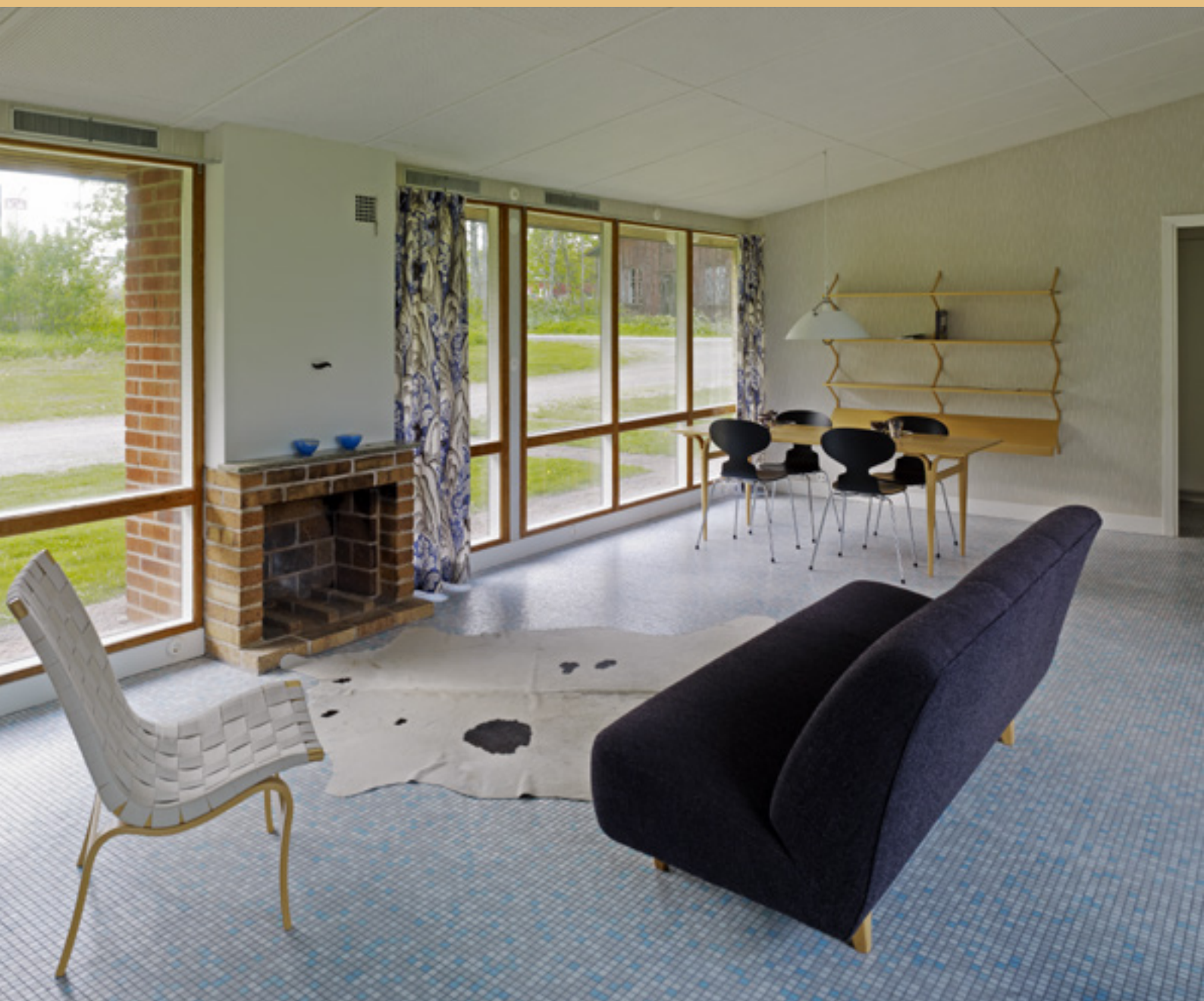
Originallägenhetens vardagsrum. Innertaket är klätt med perforerade masonitskivor. Byggmästaren har frångått anvisningarna på Mathssons detaljritning. Foto: Bert Leandersson.
