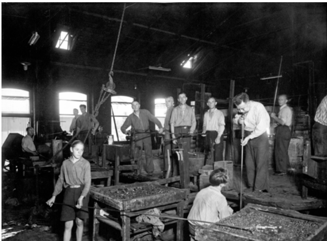
En bild från hyttan i Rosdala, någon gång på 1920-30-talet. Här ser man hur tillverkningen vid "pål och tråg" gick till. Även en av hyttpojckarna, längst till vänster fick vara med på bilden. Källa: Rosdala glasbruks arkiv
