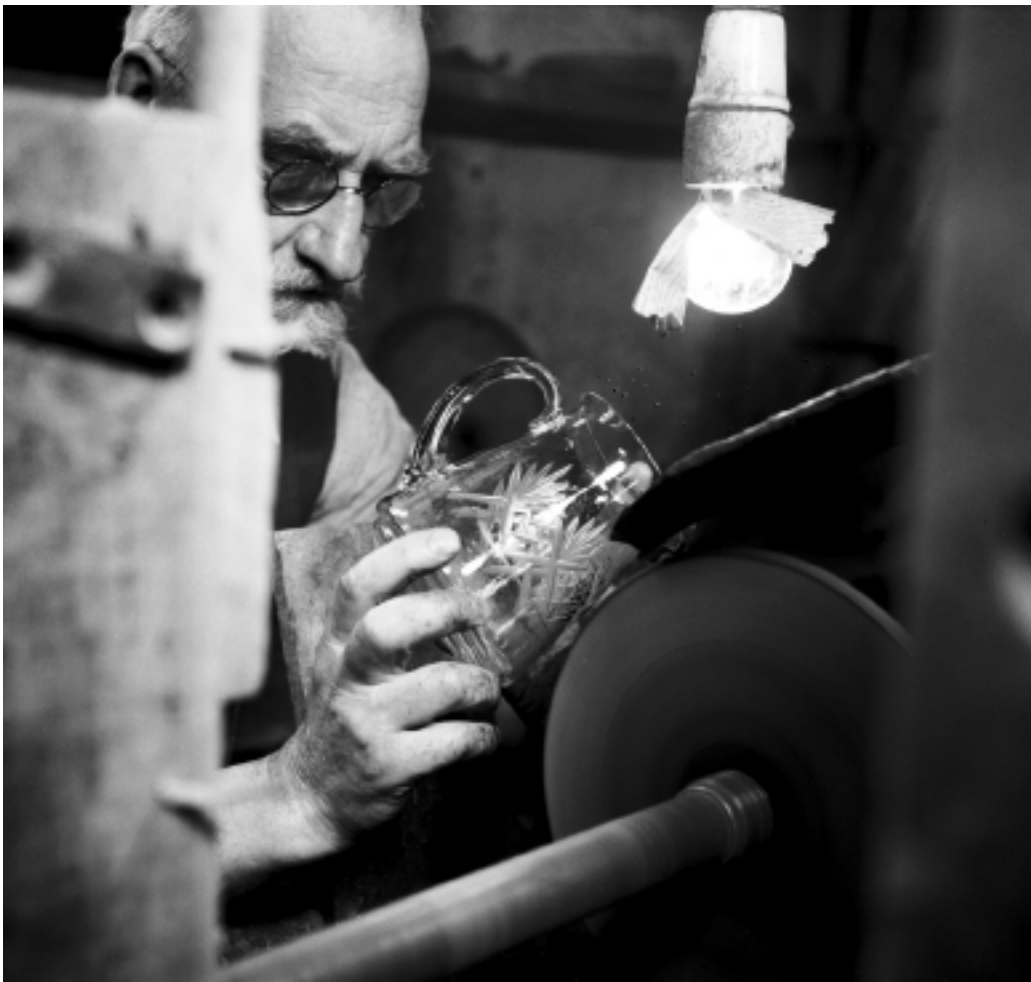
Skärslipning inne på sliperiet.
