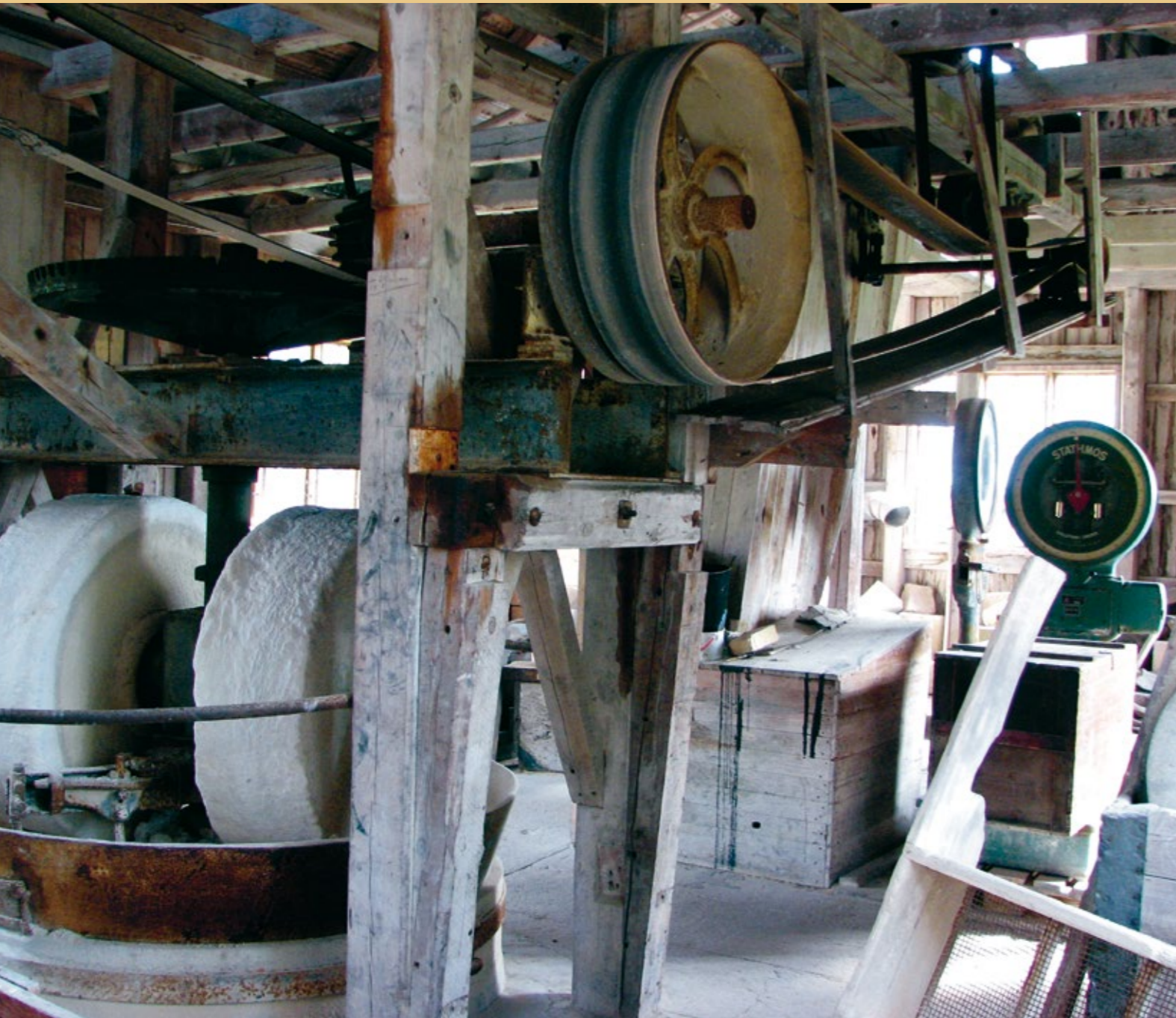
Den remdrivna degelkrossen visar oss idag hur delar av förberedelserna till glastillverkningen gjordes förr.
