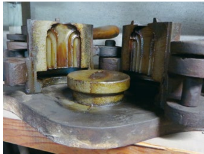
En form i gjutjärn som användes vid flasktillverkningen.
