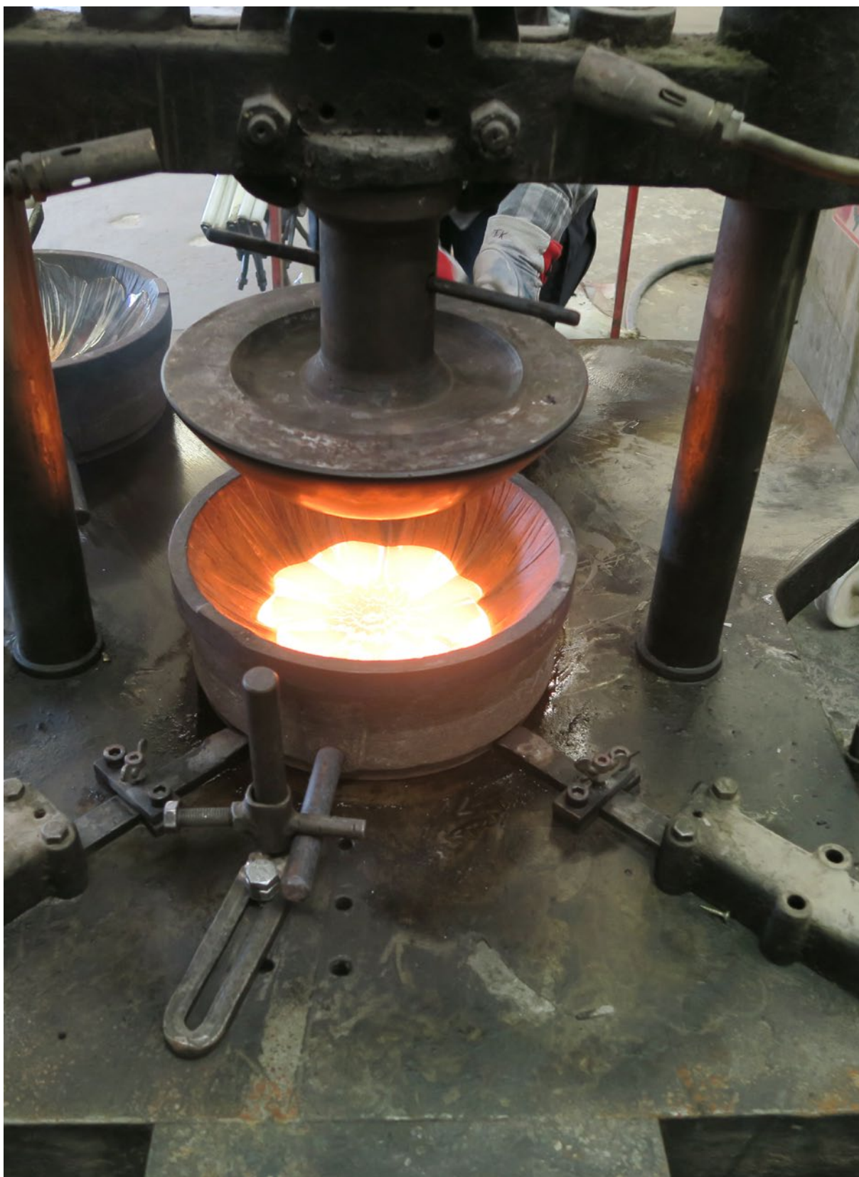
Formen är här placerad under mallen. Pressaren är beredd att trycka på en pedal som med tryckluft pressar ner mallen.
