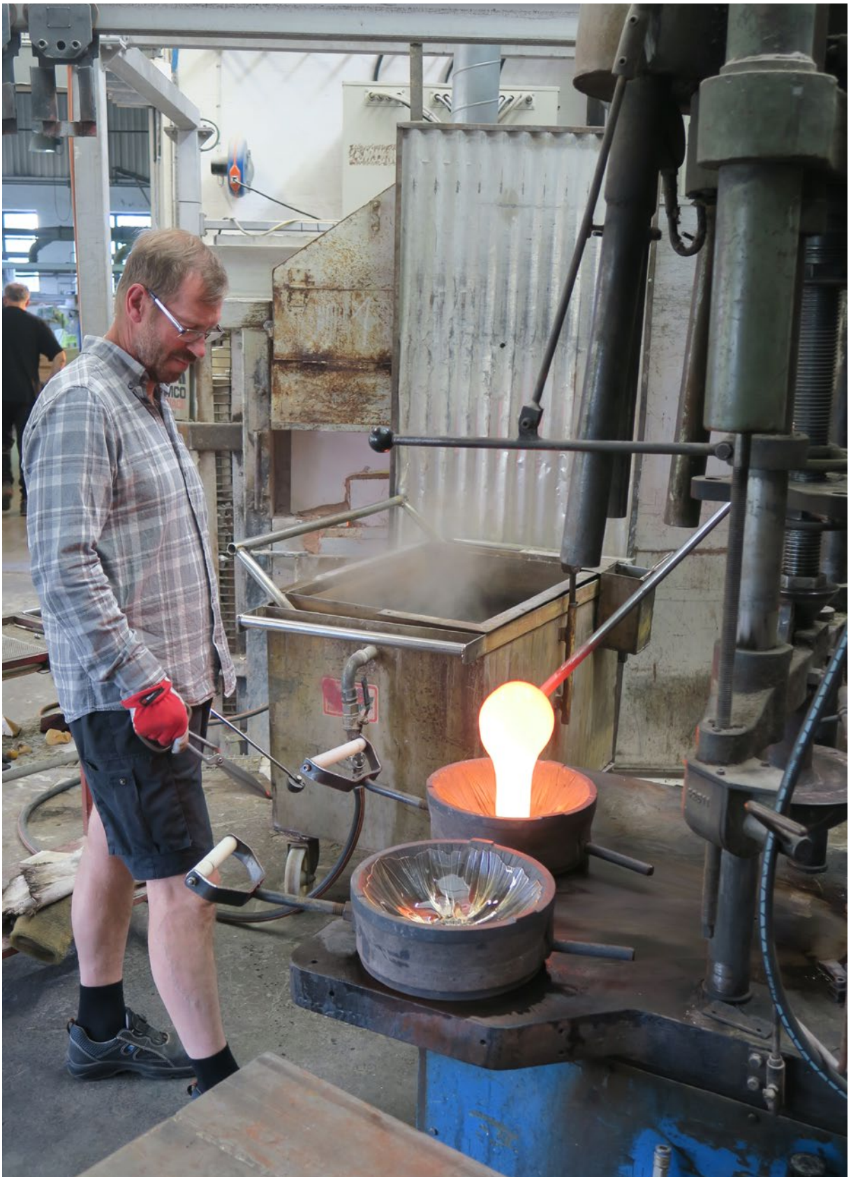
Pressaren inväntar att glasmassan rinner ner i formen.
