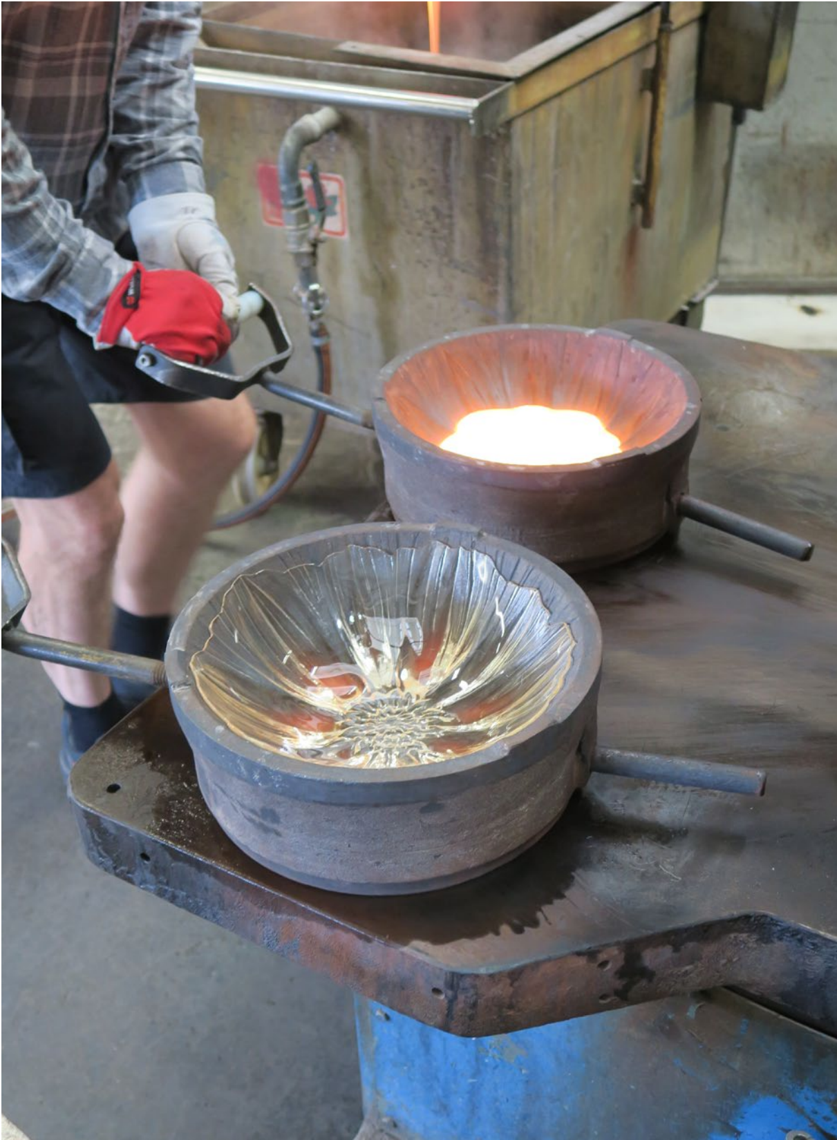
I förgrunden står en form med en färdigpressad glasskål för avsvälning. I bakgrunden syns formen med glas- massa på väg att skjutas in i pressen.
