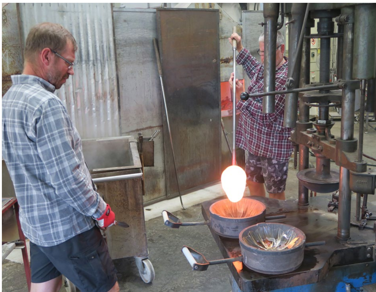
En iläggare tar en lämplig mängd av den smälta glasmassan ur ugnen på en kulspik och går över till pressen. Iläggaren håller glasmassan över formen.
