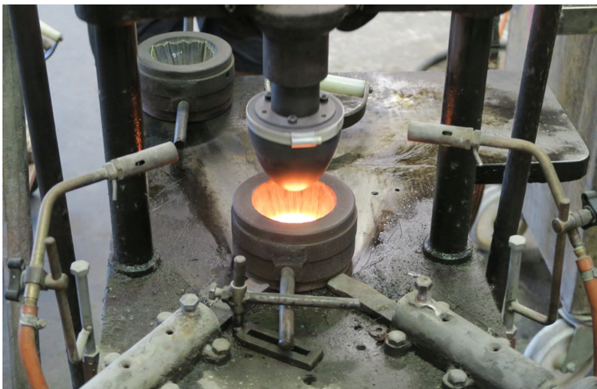
Den lilla pressen har inte en malle av gjutjärn utan av grafit. Mallen varms upp med gasol.
