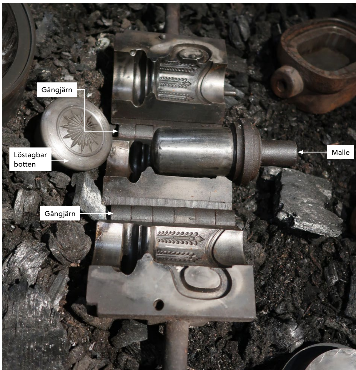
Äldre pressglasform från The Glass Factory museum. En tredelad gräddsnipeform med löstagbar botten, tillverkad vid 1900-talets början. Formen är märkt S vilket står för Stenberg, formtillverkare i Lindås, Emmaboda. En tredelad form är en förutsättning för att man som här kan få med en häinkel i själva pressmomentet. Foto: Susann Johannisson.
