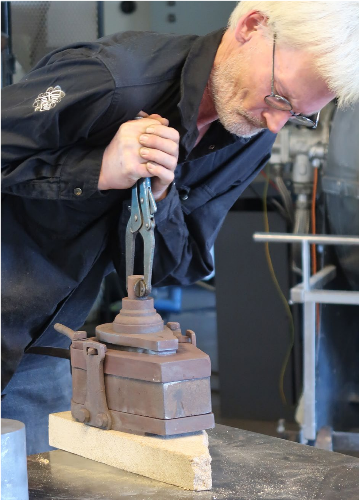
Peter pressar här själv den förvärmde mallen i formen med handkraft. Foto: Susann Johannisson.
