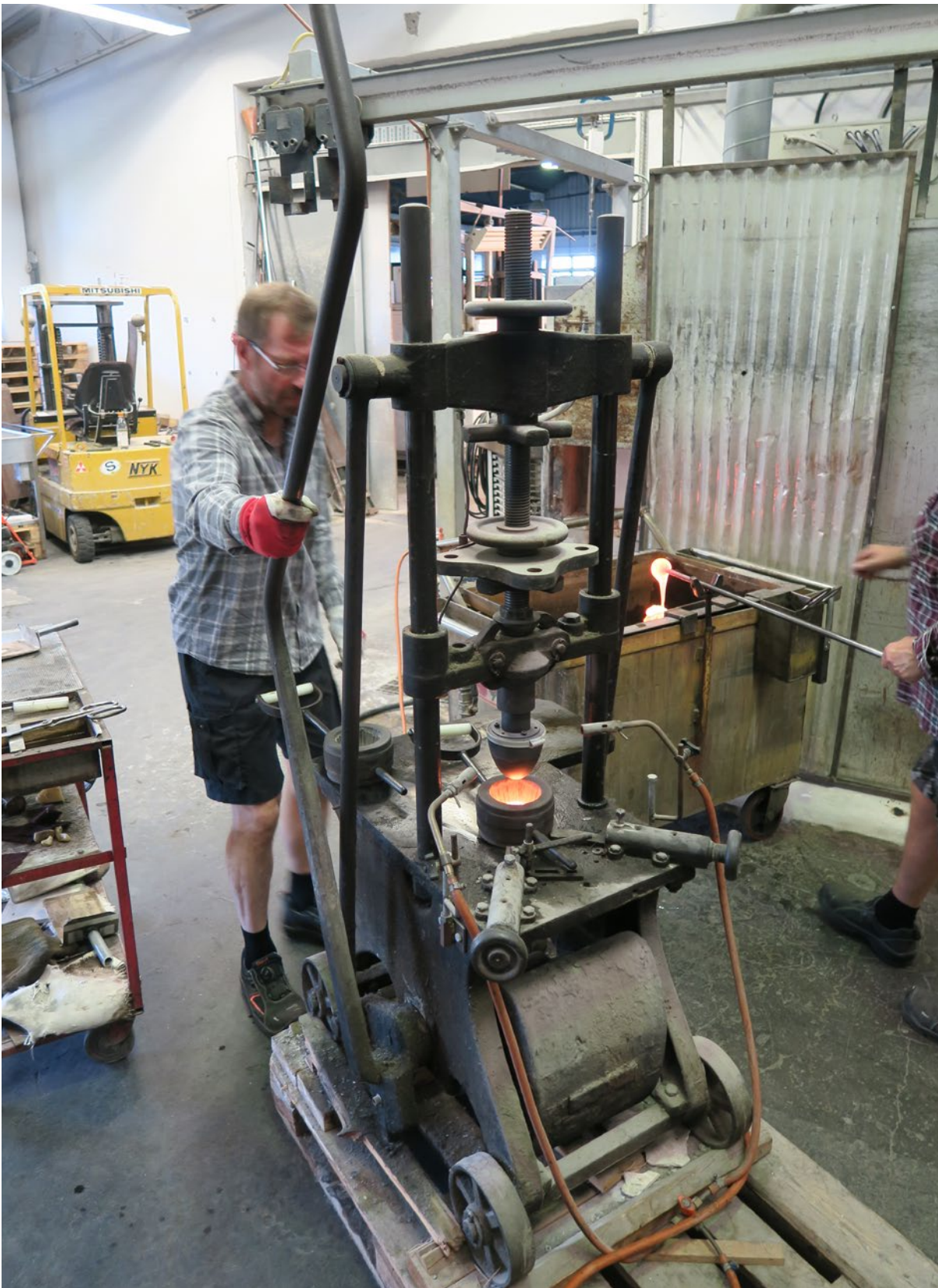
Till den lilla skålen används en mindre glaspress från 1800-talets andra hälft som har förankrats i en lastpall. Den är helt handdriven. Tommy Karlsson är pressaren på bilden.
