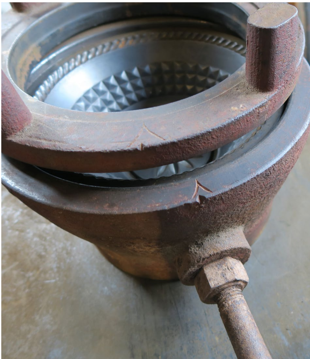
Ringen passas in med hjälp av två hjälpmarkeringar, i detta fall två V som ska överensstämma.
