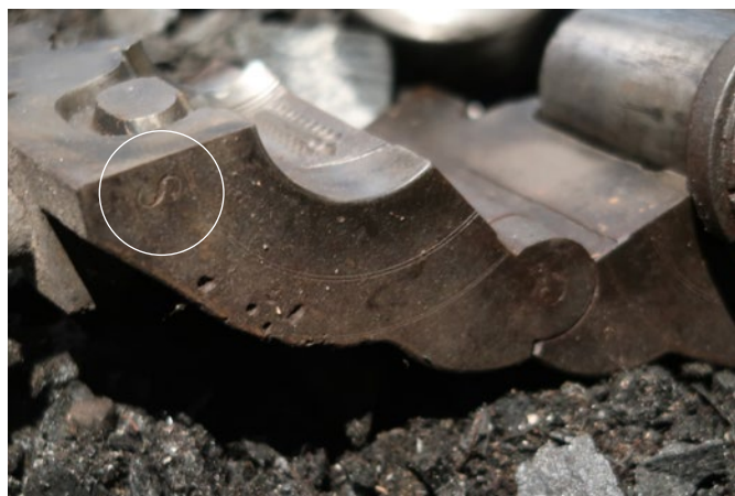
Äldre pressglasform från The Glass Factory museum. En tredelad gräddsnipeform med löstagbar botten, tillverkad vid 1900-talets början. Formen är märkt S vilket står för Stenberg, formtillverkare i Lindås, Emmaboda. En tredelad form är en förutsättning för att man som här kan få med en häinkel i själva pressmomentet. Foto: Susann Johannisson.
