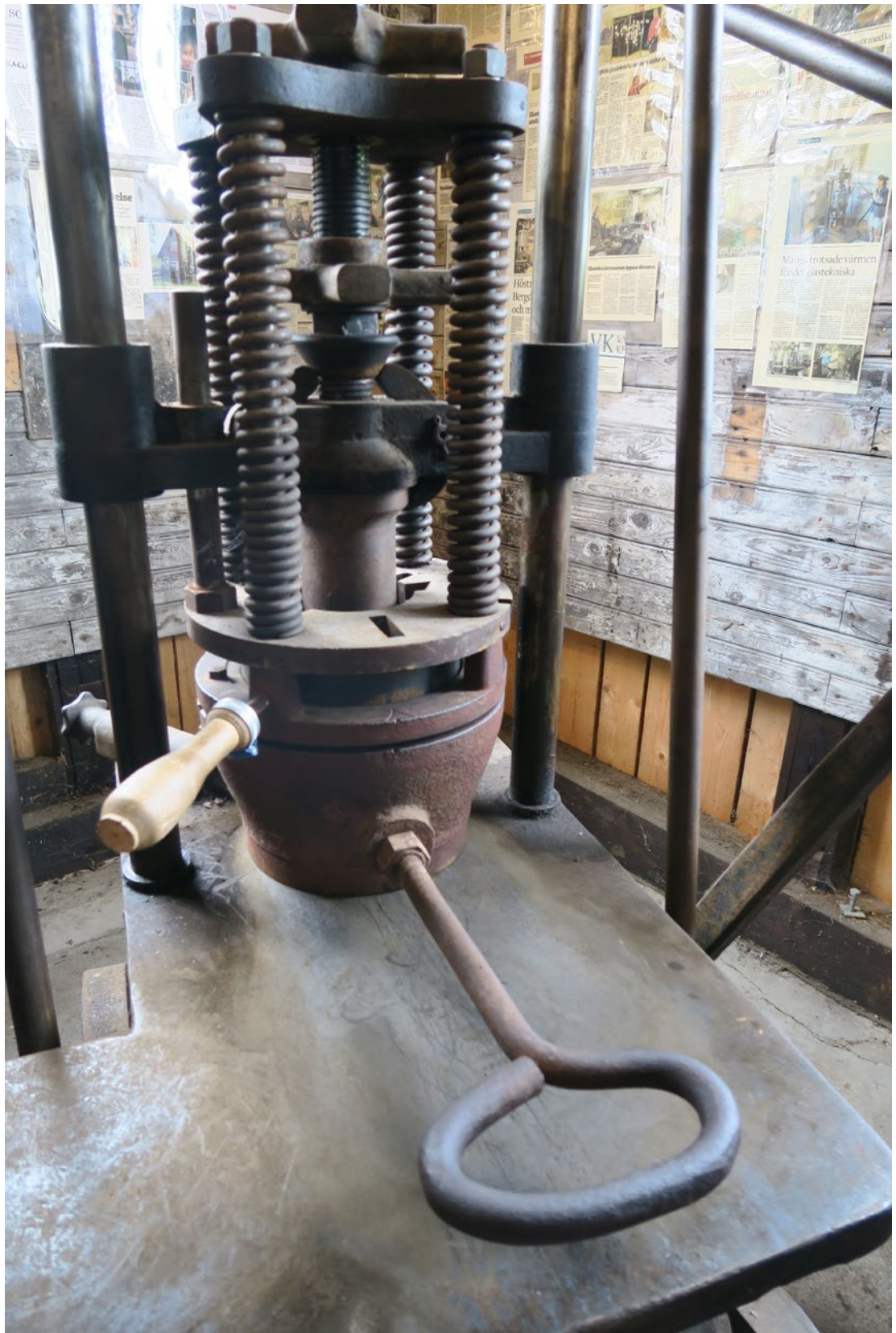
Här är överkanten på formen fixerad men mallen ännu inte nedtryckt i formen.
