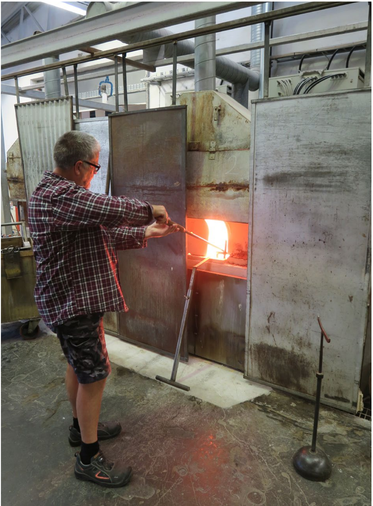
Glasmassan som värmts upp till en temperatur av 1090 grader.
