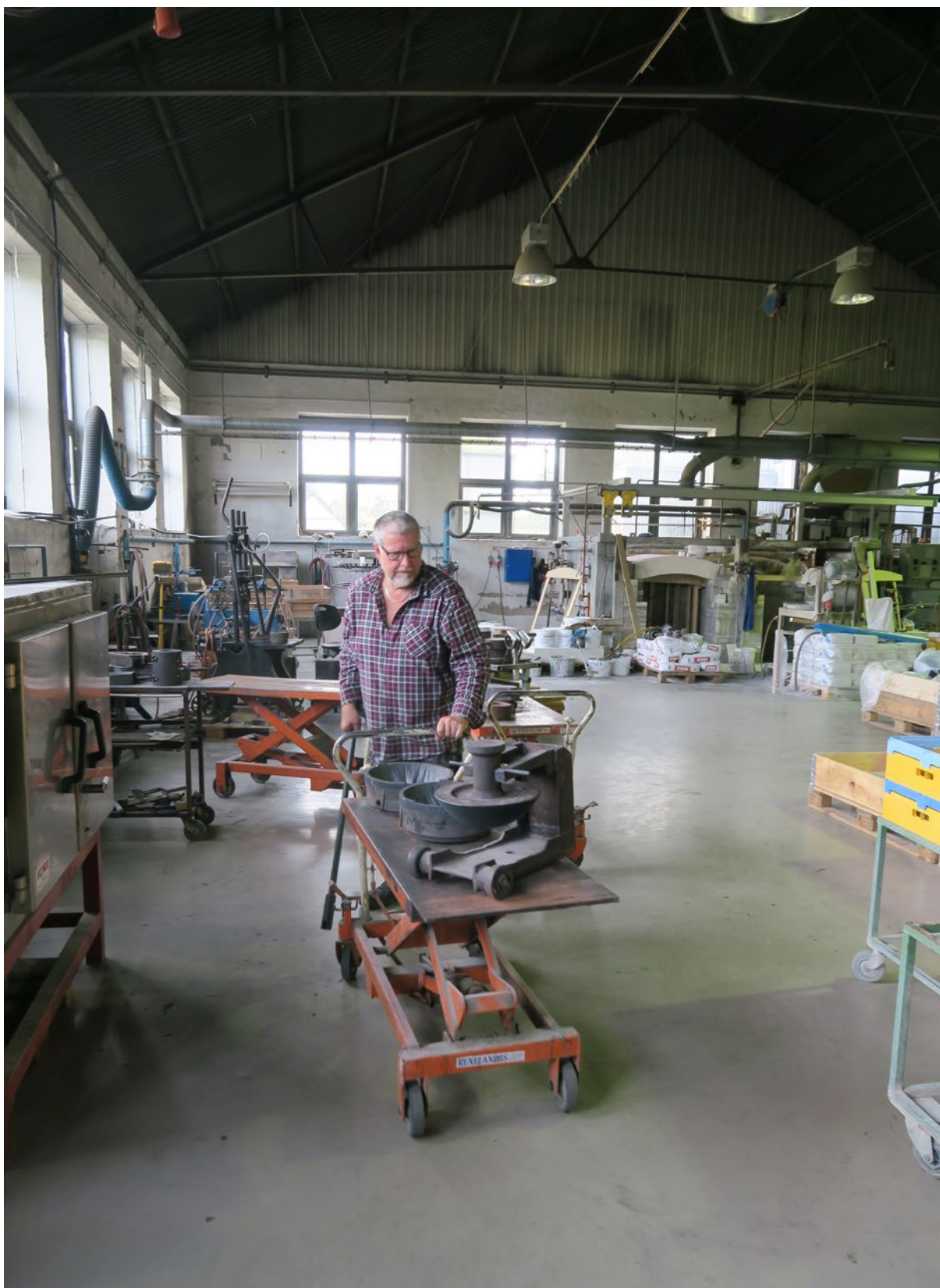
Ur värmeugnen till vänster i bild har Erik Boden tagit ut två formar och en malle som ska flyttas till pressen. De har en temperatur på 480 grader.
