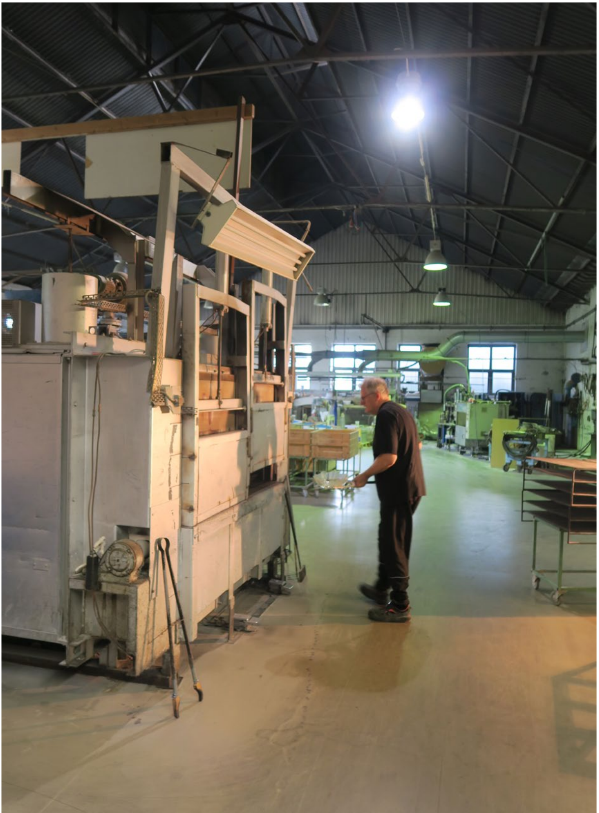
Till vänster i bilden syns kylugnen. Inbäraren har precis flyttat en nypressad glasskål till kylröret.
