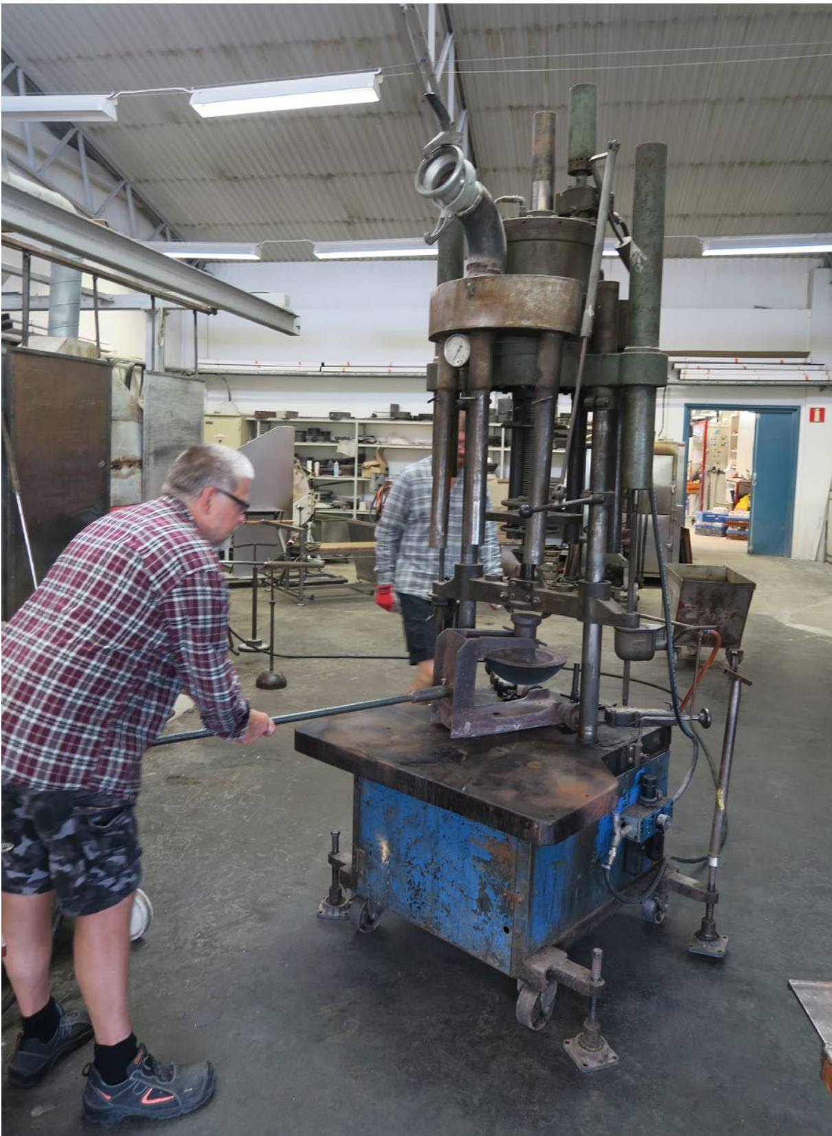
Mallen hänger på en ställning som får glida ut över pressbordet. Två griplor från pressen håller mallen på plats och därefter kan ställningen tas bort. Den här pressen är från 1900-talets mitt.
