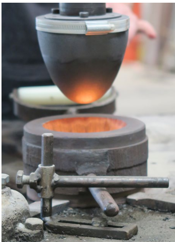
En detaljbild på mallen som i detta fall är tillverkad av grafit. Mallen är svarvad på bruket från ett cylinderformat råämne.
