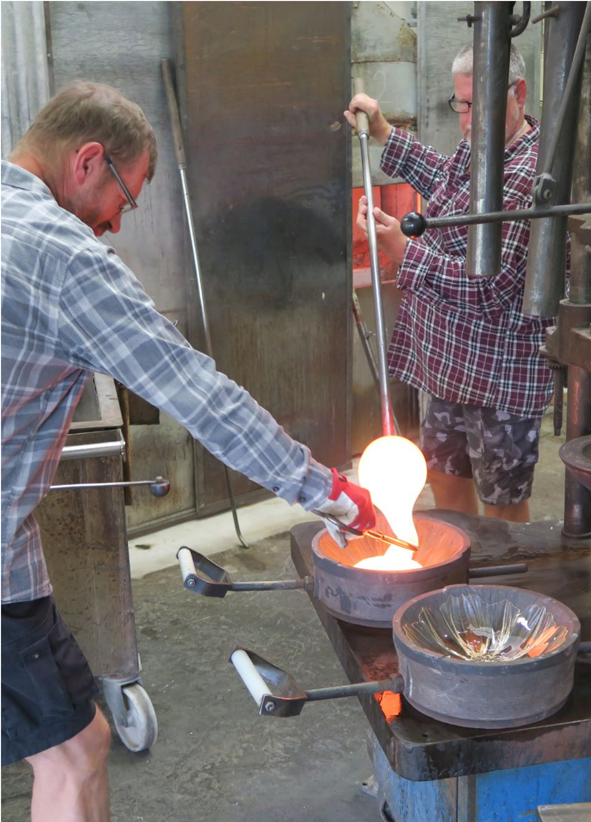
Pressaren klipper glasmassan i precis rätt ögonblick för att få önskad glasmassemängd i formen.
