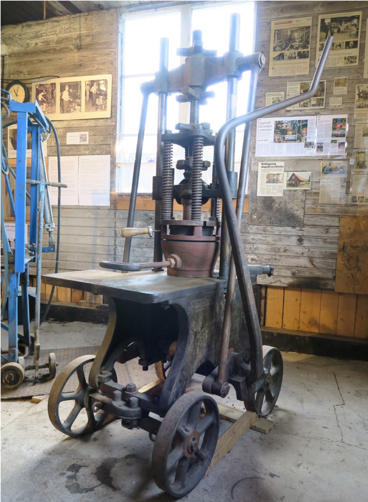
På Bergdala glastekniska museum återfinns denna glaspress från 1800-talets andra hälft. Den här glaspressen får illustrera hur en press med form och ring fungerar.
