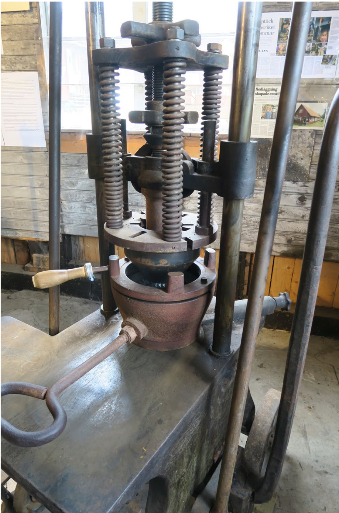
En press för formar med ring har en yttre fjäderbelastning. Här är mallen ännu inte nedpressad.
